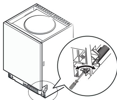
**Выравнивание машины** При установке машина должна быть выровнена по уровню. Для выравнивания машины необходимо регулировать высоту ножек.
