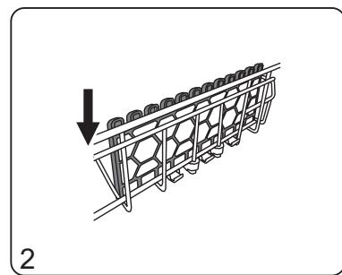
Положение откидных направляющих нижней корзины может быть отрегулировано для устойчивого размещения посуды в корзине.
